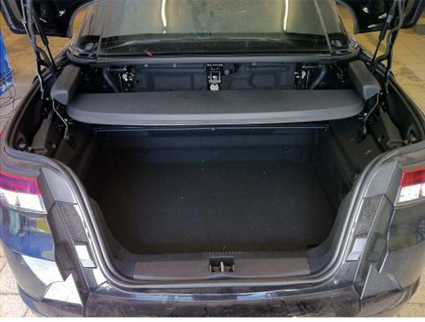
1. Verdeck komplett schliessen und Kofferraum öffnen. **WICHTIG: Vor der Installation Zündung ausschalten und Schlüssel abziehen!** Kofferraum entleeren und Bodenplatte herausnehmen.
