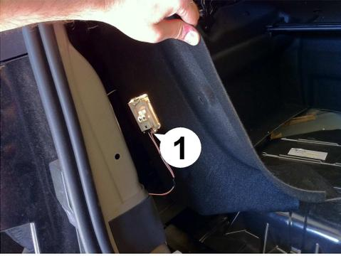
5. Den kleinen Stecker (1) von der Kofferraumleuchte abziehen. Seitlichen Sicherungshebel eindrücken und dabei vorsichtig am Stecker ziehen und wackeln.
