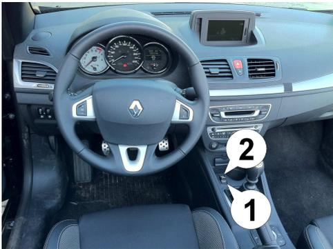
Die Programmierung erfolgt über den Verdeckschalter für Öffnen (1) und Schliessen (2) sowie den Signalgeber im Tacho. Die aktuelle Funktion sowie deren Einstellung wird über eine Pieptonsequenz ausgegeben.
