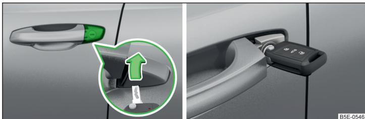
Abb. 213 Griff an der Fahrertür: abgedeckter Schließzylinder / Schließzylinder mit Schlüssel
