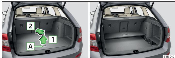
Abb. 115 Variablen Ladeboden zusammenklappen / Zusammengeklappter variabler Ladeboden in der oberen Position
