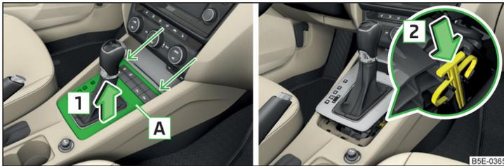
Abb. 216 Wählhebel-Notentriegelung
