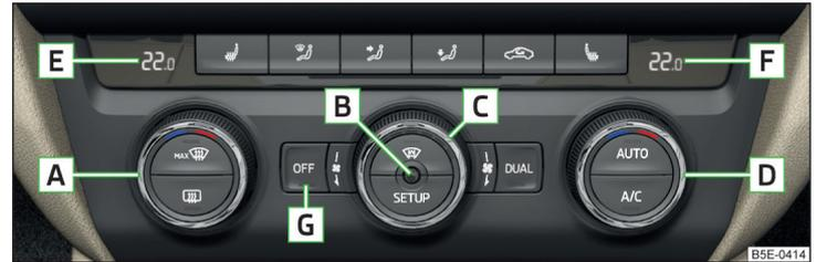
Abb. 126 Bedienungselemente der Climatronic
