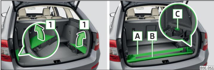
Abb. 121 Seitenabdeckungen des Gepäckraums herausnehmen / Dachgepäckträger verstauen
