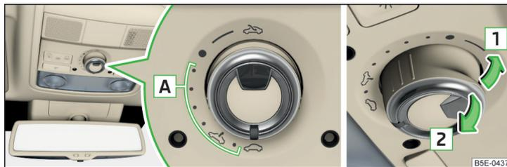
Abb. 46 Bedienung des Schiebe-/Ausstelldachs
