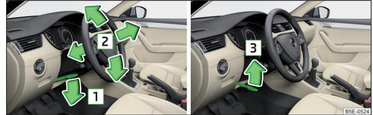
Abb. 2 Lenkradposition einstellen
