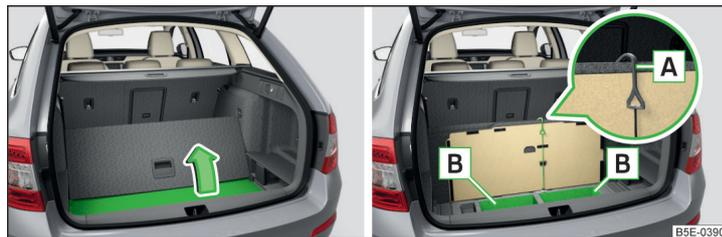
Abb. 111 Bodenbelag anheben / Ablagefächer unter dem Bodenbelag
