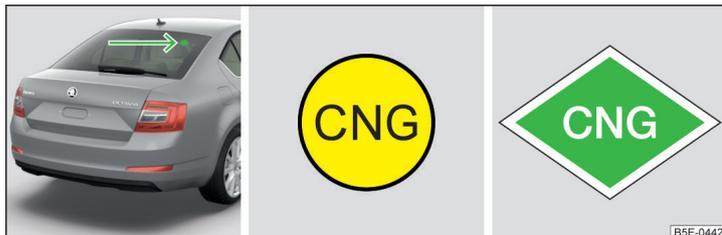
Abb. 183 Position des CNG-Aufklebers / CNG-Aufkleber
