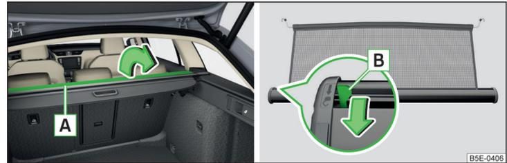
Abb. 117 Teil der aufrollbaren Gepäckraumabdeckung aufklappen / Entriegelungshebel
