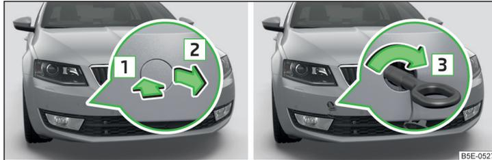
Abb. 208 Ausbau der Abdeckkappe / Einbau der Abschleppöse
