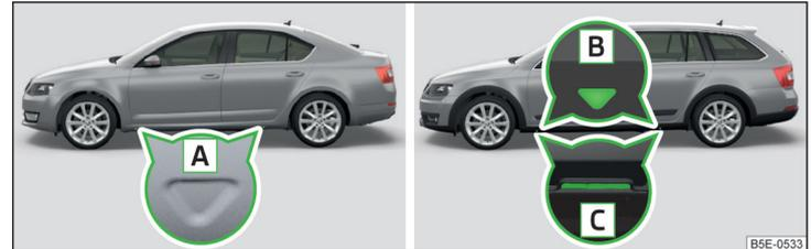
Abb. 201 Aufnahmeplätze für den Wagenheber: Variante 1 / Variante 2
