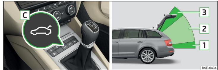
Abb. 42 Taste für die Klappenbedienung / Bedienungsbereiche
