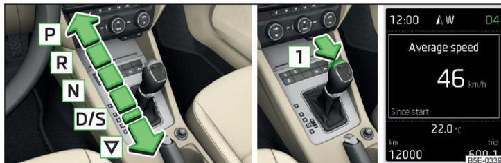
Abb. 134 Wählhebel / Sperrtaste / Displayanzeige
