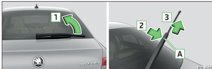
Abb. 218 Scheibenwischerblatt der Heckscheibe
