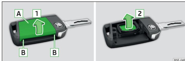
Abb. 211 Abdeckung abbauen / Batterie herausnehmen
