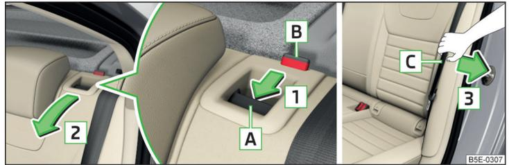
Abb. 76 Sitzlehne entriegeln und vorklappen / Gurt zur Seitenverkleidung ziehen
