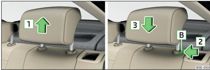
Abb. 69 Kopfstützen hinten: nach oben verschieben / nach unten verschieben
