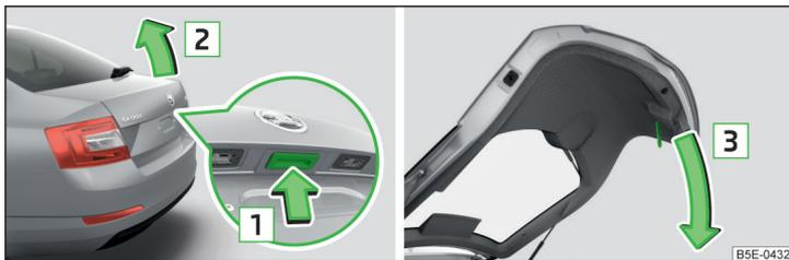
Abb. 40 Gepäckraumklappe öffnen/schließen
