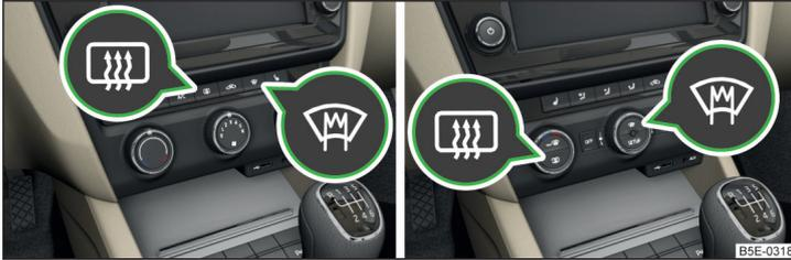
Abb. 60 Tasten für die Front- und Heckscheibenbeheizung: manuelle Klimaanlage, Heizung / Climatronic
